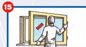
**15** Anschließend hängen Sie die Fensterflügel sorgfältig ein und testen Sie hinterher folgende Funktionen mit Vorsicht aus: öffnen, kippen, schließen.
