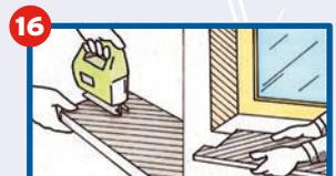
**16** Schneiden Sie die Fensterbank mit einer Stichsäge zu, passen Sie sie ein, schieben Sie die Fensterbank bis unter den Fensterrahmen und befestigen Sie diese mit dem vorher aufgetragenen Klebemörtel auf der Brüstung.
