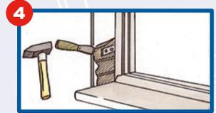
**4** Schlagen Sie die alten Maueranker mit einem Hammer heraus (oder flexen Sie diese ab). Befreien Sie die Laibung vom Putz.
