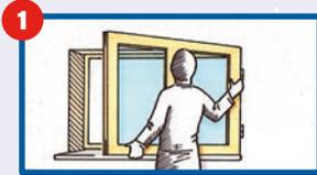
**1** Zunächst sollte der alte Fensterflügel herausgehoben werden. Bei Bedarf entfernen Sie bestehende Rahmendübel.
