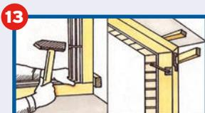
**13** Im Folgenden können Sie die Rahmendübel einsetzen und den Rahmen mit dem Mauerwerk verschrauben. Bitte die Kunststofffenster mit den Anker am Mauerwerk fest dübeln.
