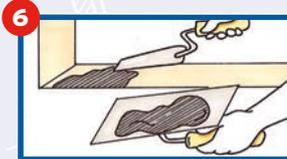
**6** Überprüfen Sie, ob beim Herausschlagen des alten Maueranker Schäden an der Brüstung oder an der Laibung entstanden sind. Falls ja, diese mit Reparaturmörtel ausbessern. Gegebenenfalls Innen- oder Außenfensterbänke austauschen.
