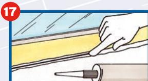
**17** Zuletzt müssen Sie die Anschlussfugen im Außen- und Innenbereich mit dauerelastischer Dichtmasse wie beispielsweise Silikon oder Acryl isolieren. Um die Dichtmasse glatt zu streichen befeuchten Sie Ihren Daumen mit einwenig Spülmittel.
