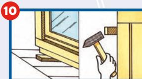
**10** Stellen Sie den Fensterrahmen nun auf Tragklötze in die Maueröffnung und fixieren Sie diesen mit Keilen und Distanzklötzen nach allen Seiten. Zum Durchführen können Sie dünne Holzstreifen unter die Klötze hinlegen.
