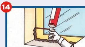
**14** Schäumen Sie die Fugen vollständig zwischen Rahmen und Mauer von unten nach oben mit Zwei-Komponenten-Montageschaum aus. Bitte reinigen Sie den Rahmen umgehend und trennen Sie den ausgehärteten Schaum ab.
